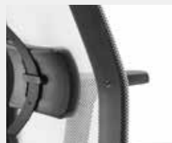
Lumbalstütze (L18): 4 cm höhen- und 1,5 cm tiefenverstellbar, flexibel gelagert. Lumbar support (L18): Height-adjustable (4 cm) and depth-adjustable (1.5 cm), flexibly mounted.
